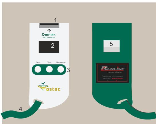
Расположение органов управления счетчиком показано на рисунке. На верхней панели (слева) цифрами обозначены прижим (1), дисплей (2), кнопки управления «Свет», «Сброс», «Множитель» (3), ремешок для переноски (4). На нижней части корпуса обозначена клавиша подъема прижима (5).
